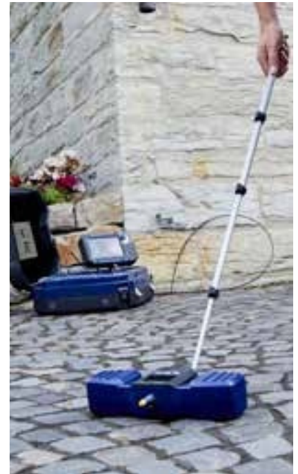
Con el localizador Wöhler L 200, el cabezal de la cámara se puede localizar con una precisión milimétrica.
